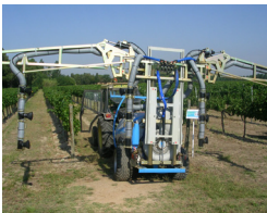
Figura 26: Pulverizador que envuelve toda la hilera de vegetación
