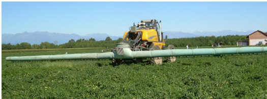
Figure 24: Barra de pulverización con asistencia de aire
