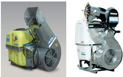
Fig. 18: Cañón de pulverización, muy vulnerable a la deriva
