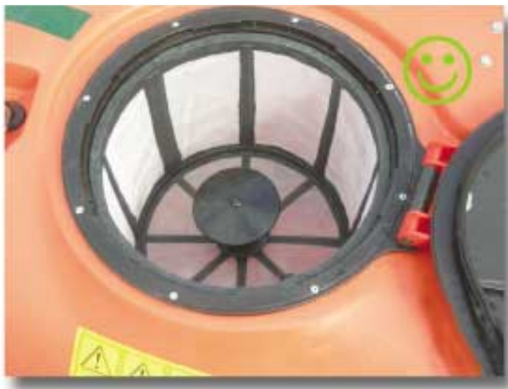
Figura 17. La tapa del depósito debe ser solidaria al mismo para evitar pérdidas o aperturas accidentales (foto INSAD)
