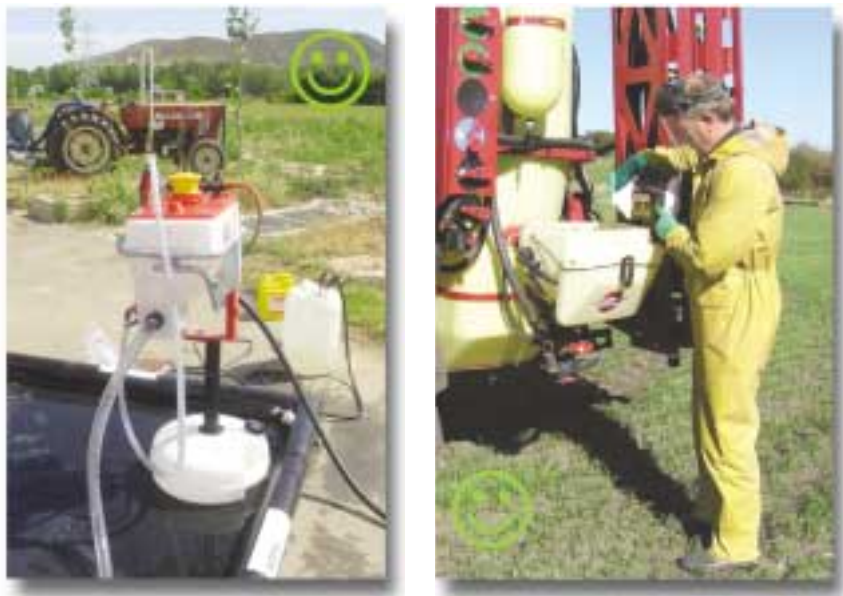
Figura 27. Los incorporadores de producto facilitan las operaciones y reducen el riesgo de contaminación (foto UPC y HARDI INTERNATIONAL A/S)
