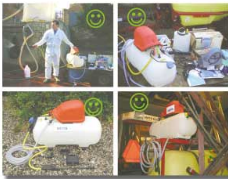
Figura 51. Utilice equipos adecuados para la limpieza externa e interna del pulverizador. Estos pueden ser del propio pulverizador o ajenos a él (foto AAMS Ibérica y UPC)
