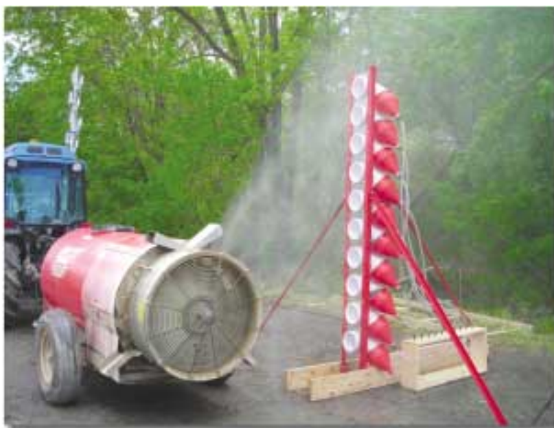
Figura 22. La adaptación al perfil de la vegetación: factor clave en aplicaciones en frutales y viña (foto UPC)
