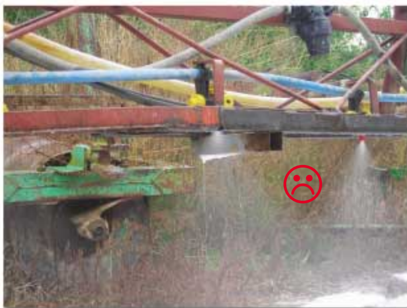
Figura 43. Un adecuado diseño y mantenimiento evitan problemas de contaminación por goteo (foto UPC)
