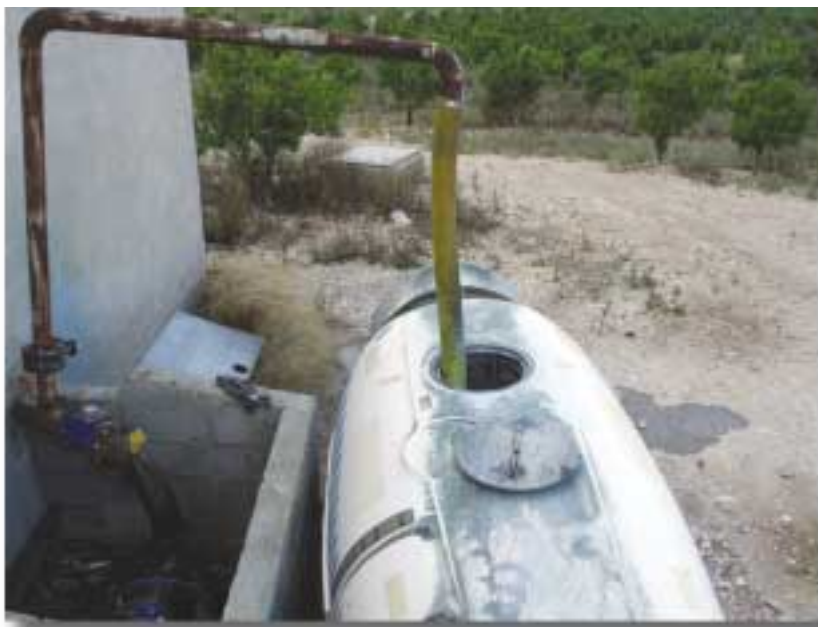
Figura 25. No deje nunca el equipo desatendido durante el proceso de llenado (foto CMA)
