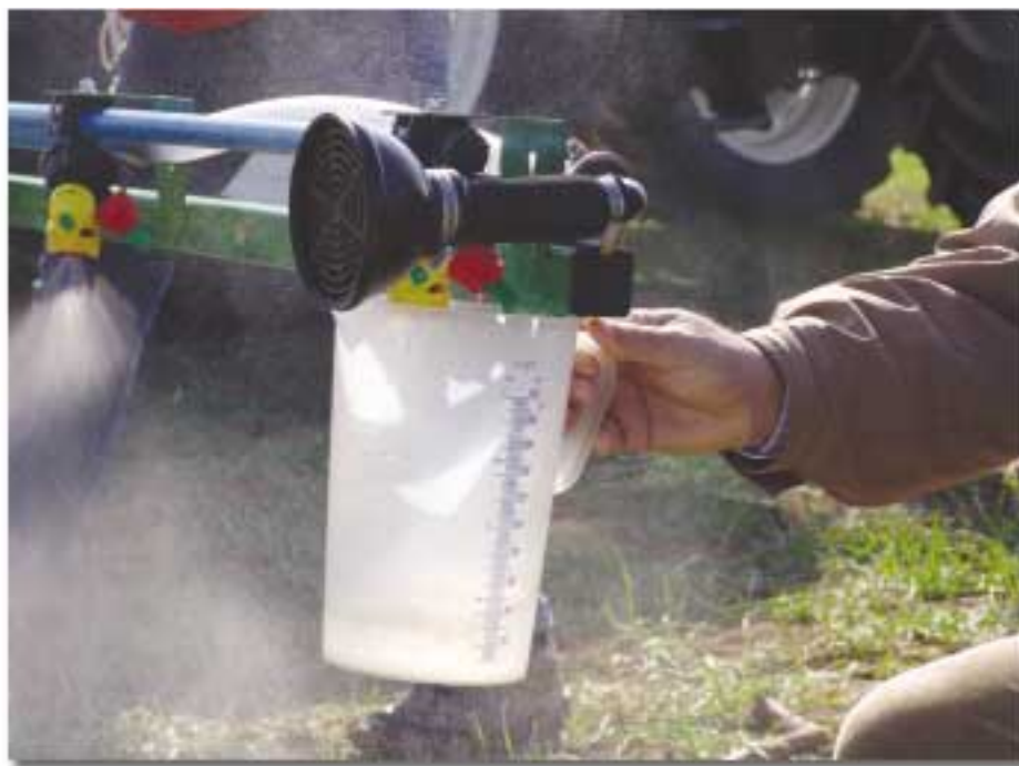
Figura 19. Comprobar periódicamente el caudal emitido por las boquillas y sustituirlas cuando éste difiera más de un 10% del caudal teórico según el fabricante
