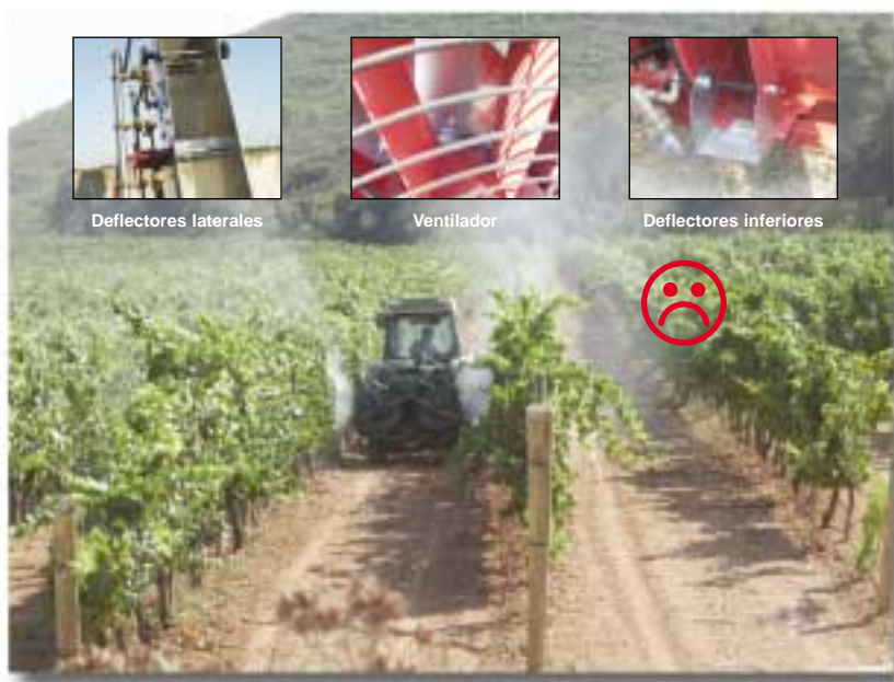
Figura 38. La deriva se puede reducir ajustando correctamente los elementos del equipo de aplicación (foto UPC)
