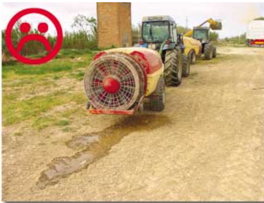
Figura 34. Antes de iniciar el desplazamiento es preciso comprobar el correcto estado del equipo (foto CMA)
