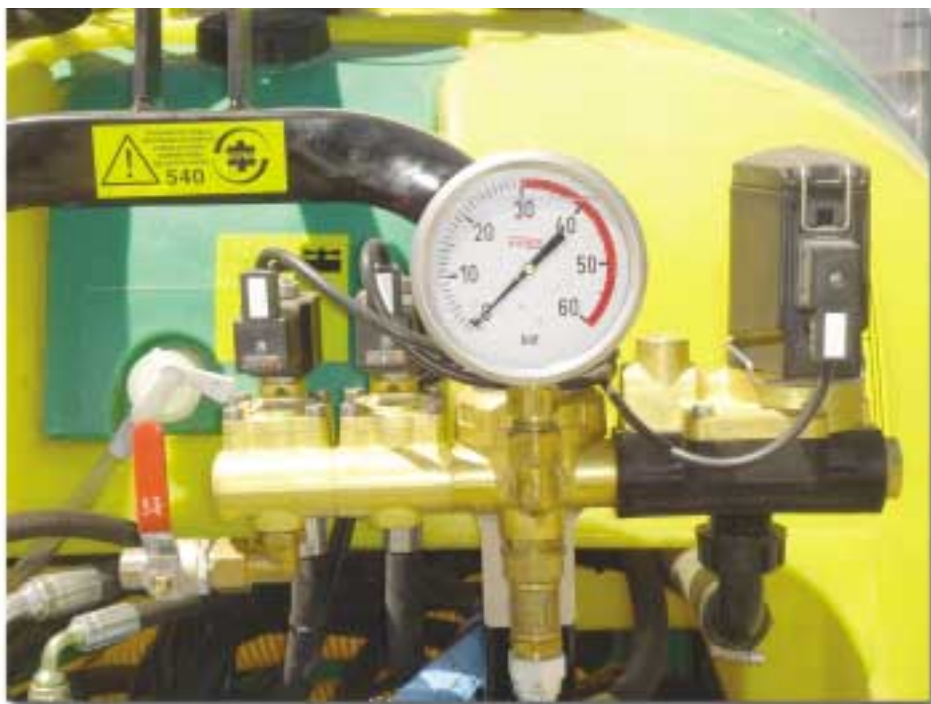
Figura 18. El manómetro debe ser perfectamente legible desde el asiento del conductor (foto UPC)
