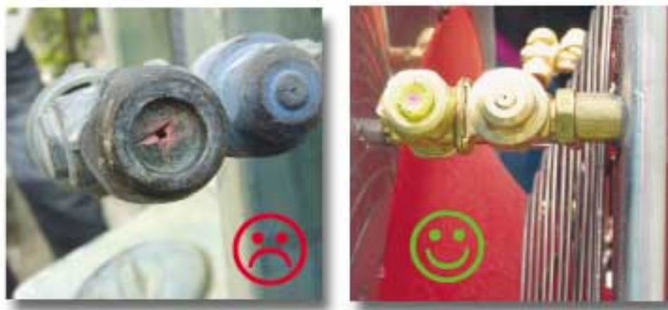
Figura 13. La boquilla es uno de los elementos clave. Una correcta elección es fundamental (foto UPC)
