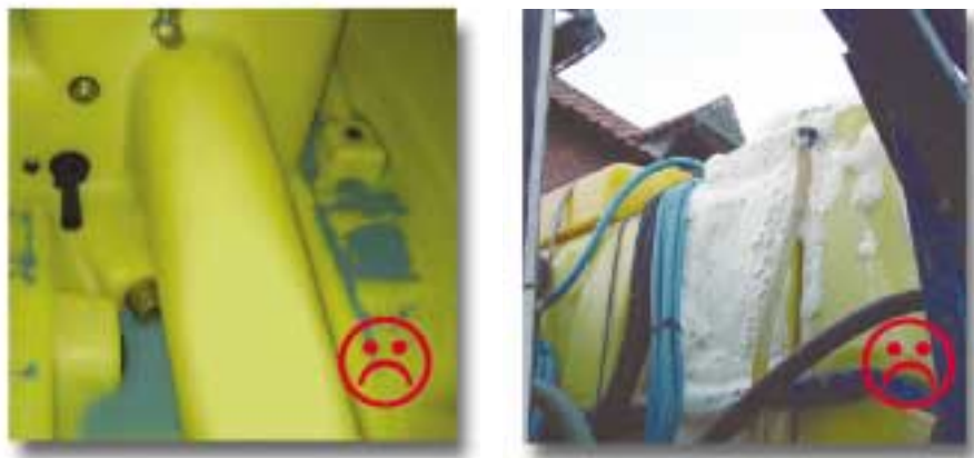
Figura 29. Dos de las fuentes más importantes de contaminación puntual: el volumen residual en el depósito y las pérdidas por exceso de carga (foto DEIAFA)
