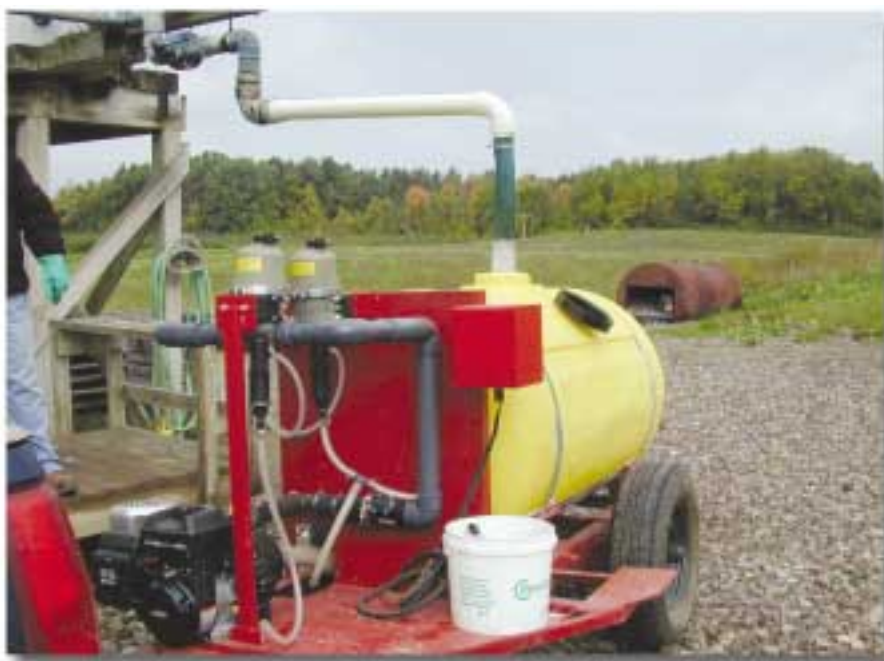
Figura 26. Utilice sistemas de llenado "discontinuos" que impiden el contacto con el agua del depósito (foto UPC)
