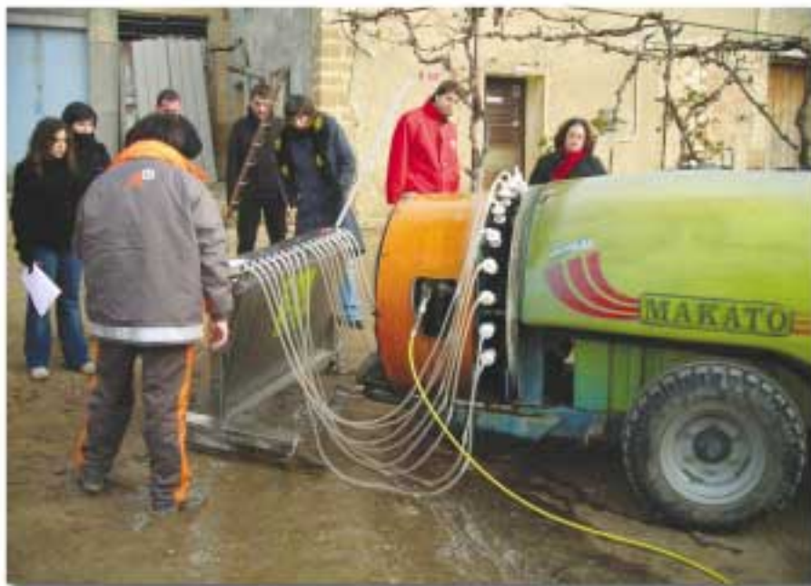
Figura 21. La inspección de equipos de tratamientos, una acción importante para reducir la contaminación (foto UPC)
