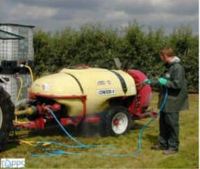
Los productos fitosanitarios eliminados en la limpieza en el campo son metabolizados (destruidos) por microorganismos del suelo. No limpie su pulverizador en el patio de la explotación o sobre cualquier superficie dura que no disponga de suelo biológicamente activo capaz de metabolizar los residuos de la limpieza.
