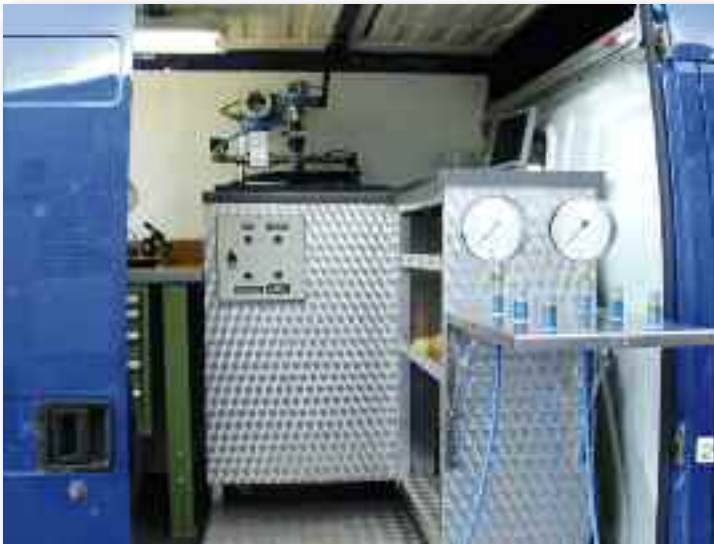
Banco automático para la determinación del caudal de las boquillas
