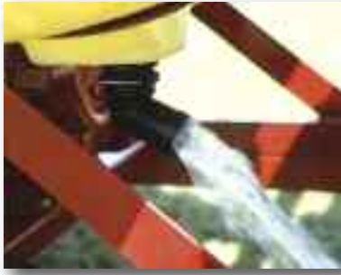
Vaciado correcto con válvula de vaciado del depósito
