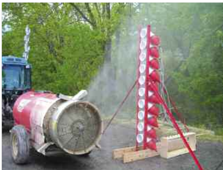
Medida de la distribución vertical de líquido (opcional)
