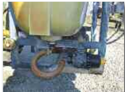
Depósito sin sistema de vaciado o con sistema poco funcional
