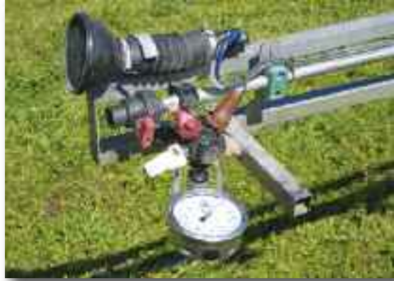
Manómetros para la comprobación del equilibrio de presiones entre los diferentes sectores de la barra
