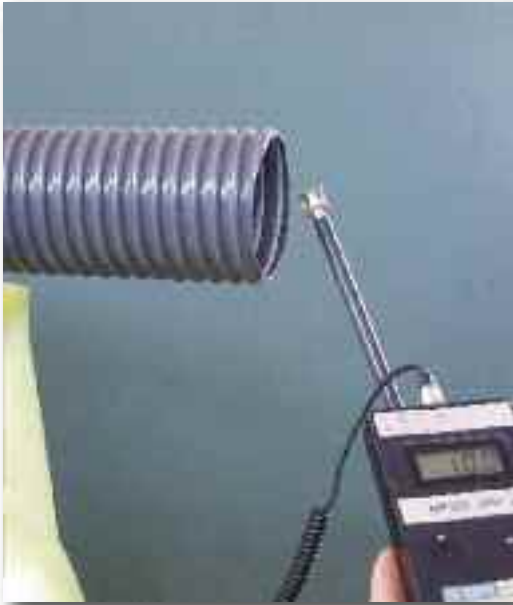
Comprobación con anemómetro de simetría en los caudales de aire para salidas opuestas
