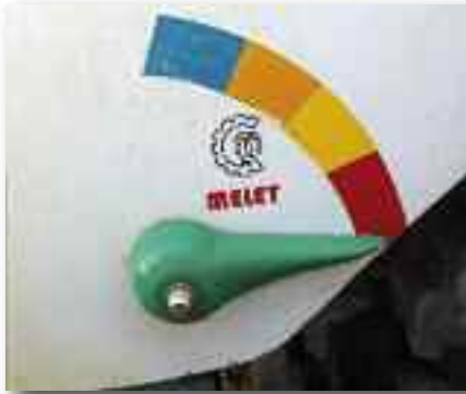
Indicador de nivel correcto y visible desde el punto de conducción y desde el punto de llenado
