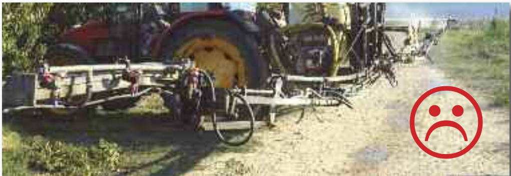
La barra no presenta la estabilidad necesaria. Alguno de los tramos no mantiene su posición horizontal
