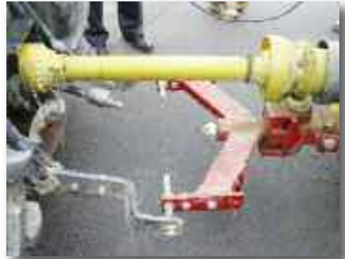
No existe la cadena de fijación en el árbol de la máquina
