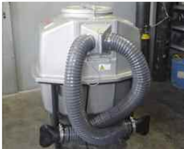
Equipo con ausencia de pliegues o deformaciones excesivos que puedan dificultar el paso del aire
