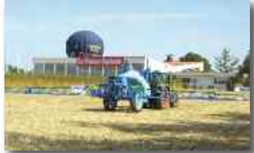
La barra debe mantenerse horizontal y estable
