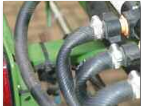
Existen problemas de curvatura o abrasión en algunos puntos de la tubería
