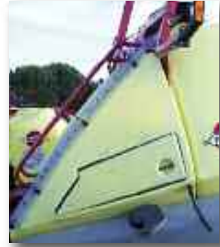
Indicador de nivel correcto y visible desde el punto de conducción y desde el punto de llenado
