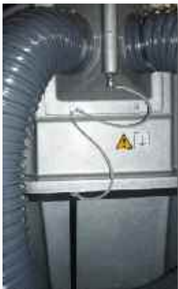
Partes metálicas del equipo conectadas entre sí
