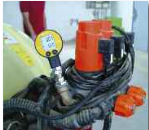
Si el manómetro del equipo no puede desmontarse y/o se trata de un instrumento electrónico, la contrastación se puede realizar instalando un manómetro contrastado en la máquina y haciendo la contrastación pertinente
