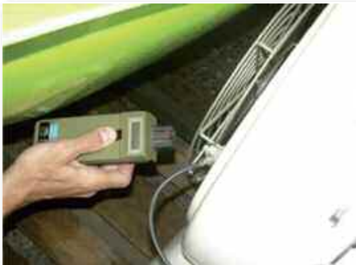
Comprobación del régimen de giro de la turbina utilizando un tacómetro
