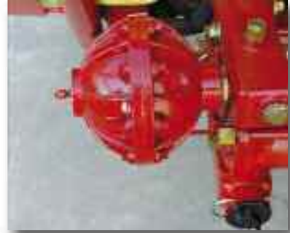
Presencia y presión correcta de los compensadores de presión (calderín)
