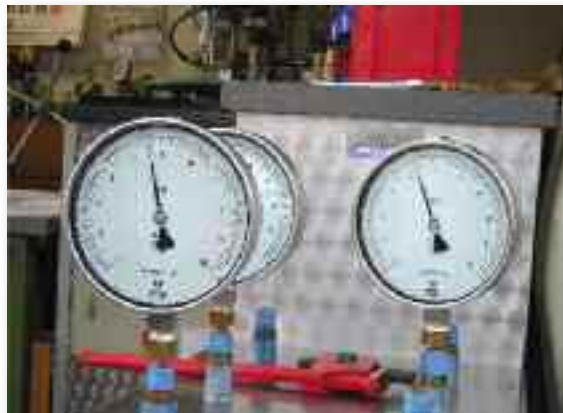
Consola de múltiples manómetros para el control simultáneo de la presión en los diferentes sectores de una barra
