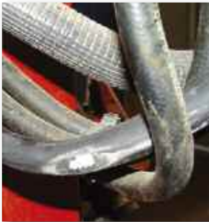
Existen problemas de curvatura o abrasión en algunos puntos de la tubería
